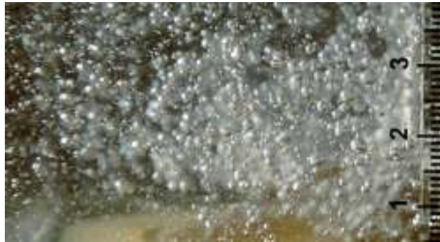
Foto2. Tamanho das bolhas geradas no processo de flotação
