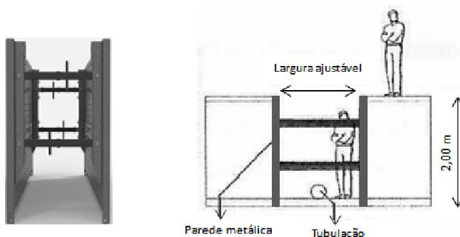
O escoramento blindado tem por finalidade escorar a superfície lateral das valas, através de conjunto de placas metálicas e estroncas, evitando o desmoronamento de terra.
